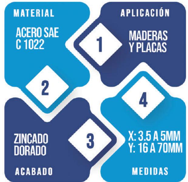
SE RECOMIENDA EL USO CON ATORNILLADORES AUTOMÁTICOS CON REGULACIÓN DE TORQUE Y PUNTAS ACORDES SEGUN EL TAMAÑO DEL TORNILLO.
